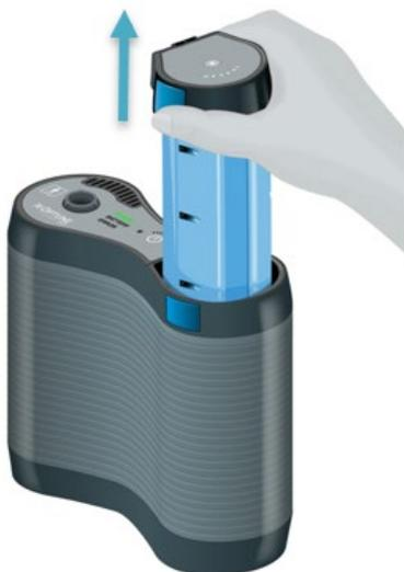
Ricaricare le batterie nel caricabatterie (vedere Sezione 15) per quattro/cinque ore. Le batterie rimarranno cariche per breve tempo se sono al di fuori del caricabatterie (ore ma non giorni). Per questo motivo, tenere sempre le altre batterie nel caricabatterie, se possibile.
