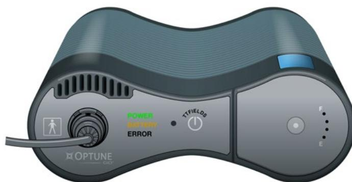
Quando la batteria si esaurisce (dopo circa 2-3 ore), verrà emesso un segnale di avviso e il trattamento con i TFields si interromperà. Quando ciò accade, la spia "Battery" (batteria) diventa gialla e si accende la spia "Error" (errore) rossa. Il suono del segnale di avviso è lo stesso emesso dal dispositivo per un errore. Tuttavia, in questo caso si accendono entrambe le spie "Battery" (batteria) gialla ed "Error" (errore) rossa e non solo la spia rossa.
