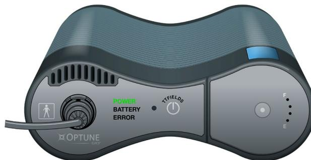
Se è installata una batteria carica e l'alimentatore non è collegato, anche la spia "Battery" (batteria) si accenderà e diventerà verde.
